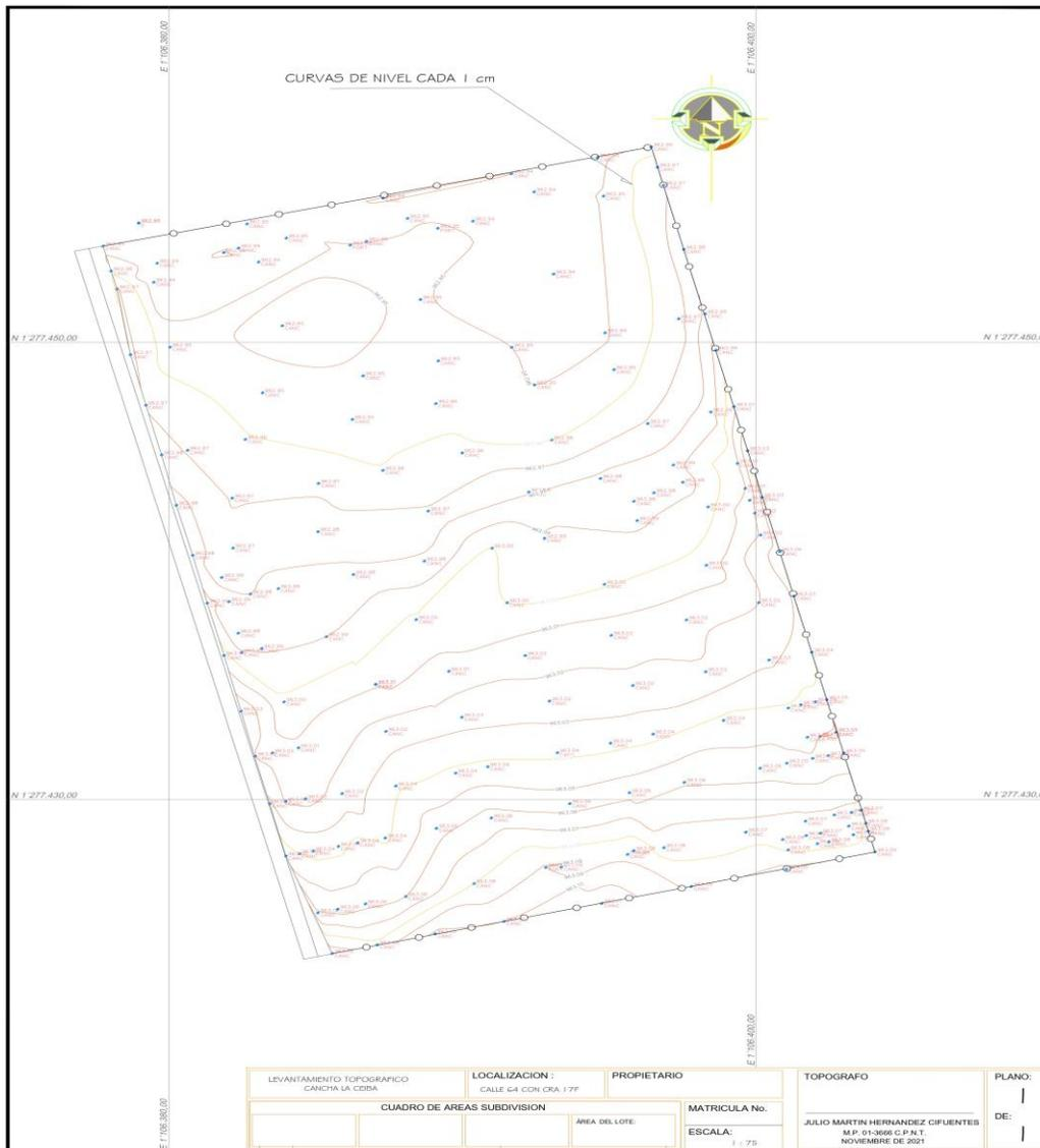
**Levantamiento topográfico con curvas de Nivel**
